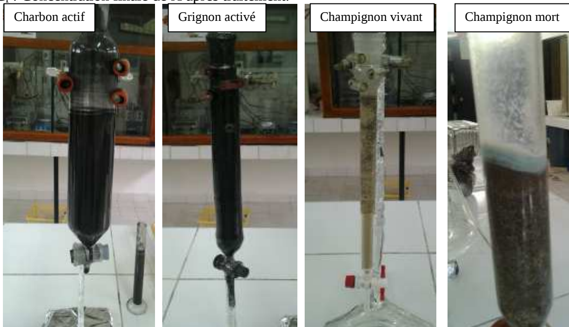
Figure 8 : Les différentes colonnes de filtration utilisées pour l'épuration des effluents de dinanderie .
