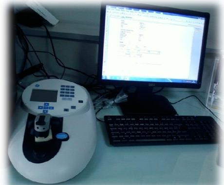
**Fig 21** : dosage d'ADN par NanoDrop
