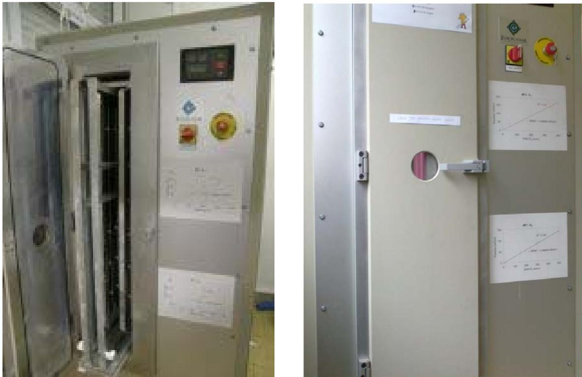
**Figure 13: Réacteur plasma froid radiofréquence utilisé.**
