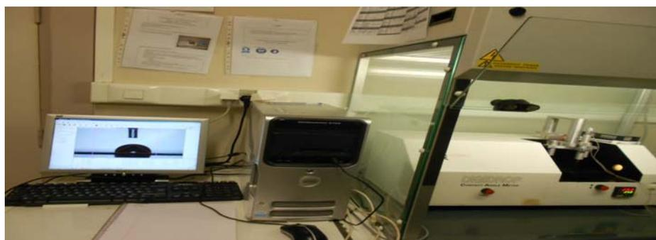
**Figure 22:** appareil utilisé pour la mesure de l'angle de contact
