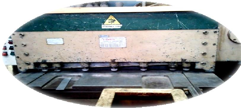
**Image 1 : Machine de découpage automatique.**
