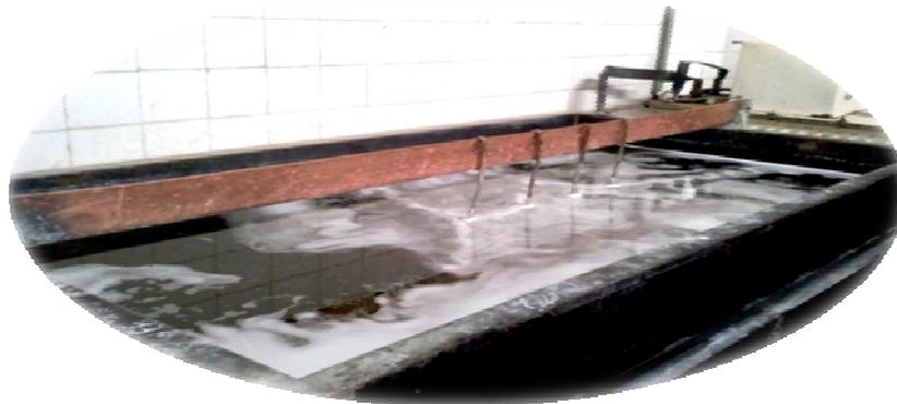
Image 7 : Bain de dégraissage électrolytique dans la SADF
