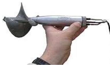
Figure 1 : Moulinet à hélice
