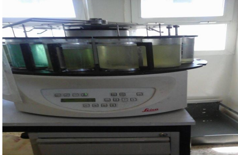
Figure2 : Histokinette, Automate permettant l'inclusion des échantillons fixés dans de la paraffine après déshydratation.
