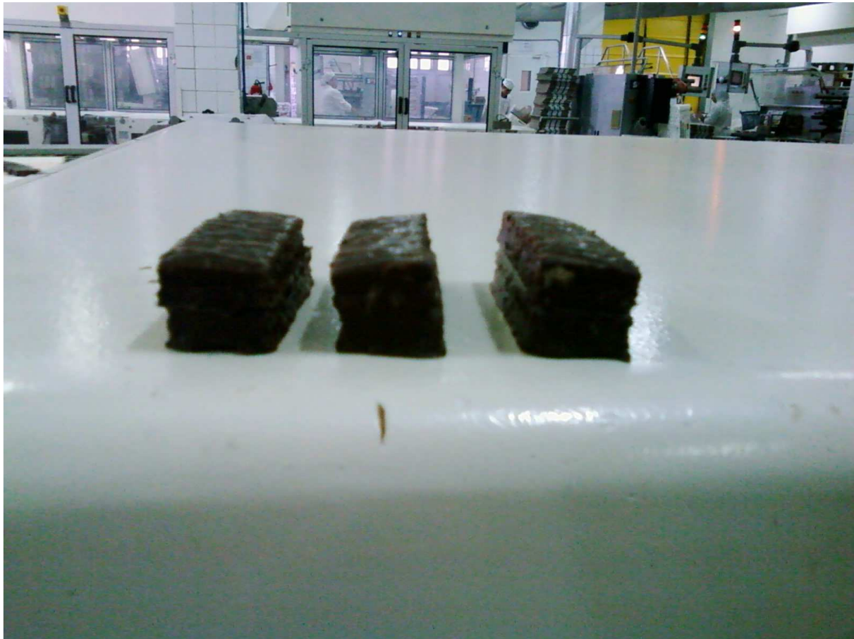
Figure 8 : problème de décalage de MERENDINA-MINI
