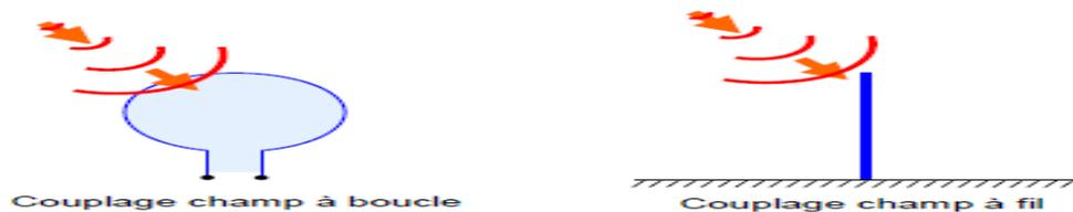
*Figure 24: Principe du couplage par champ électromagnétique*
