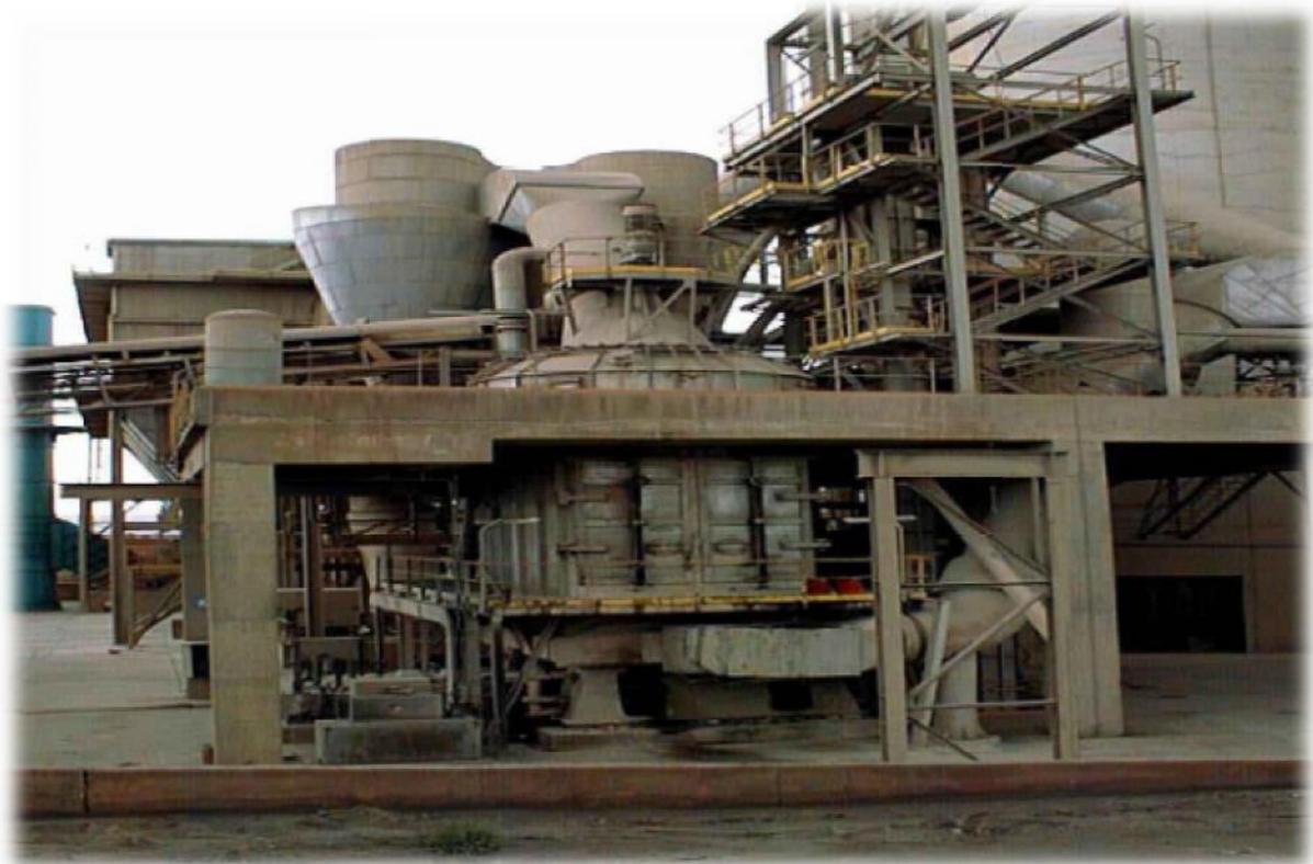
Figure 10 : broyeur vertical à deux paires de galets.
