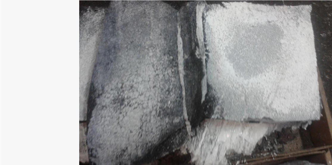
Figure 2: L'éponge utilisée pour diminuer la quantité de peinture transportée
