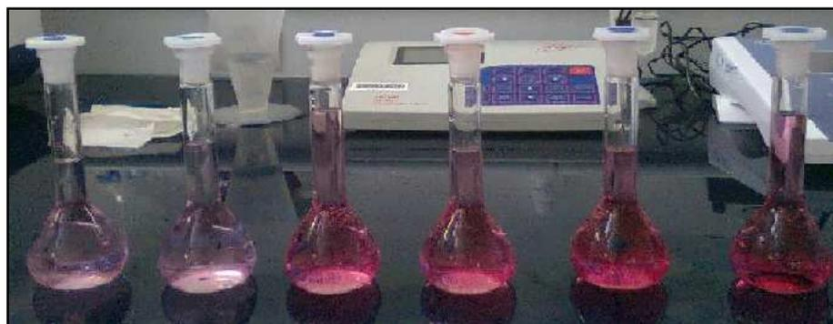
Photo 3 : Colorations obtenues de la gamme d'étalonnage
