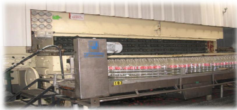
**Figure N°14: Laveuse des bouteilles**
