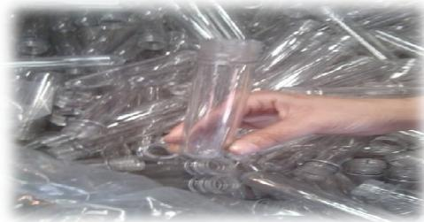
*Figure N° 12 : Préforme*
