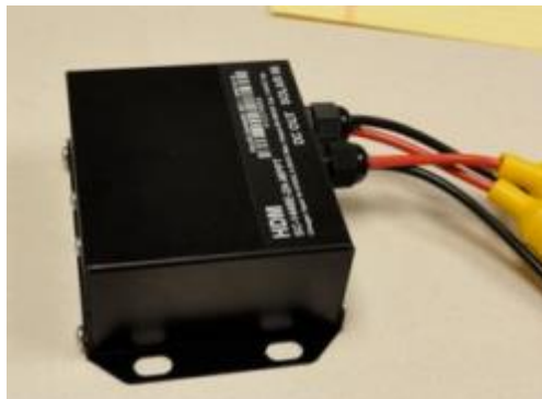
Figure 74 : MPPT « maximum power point tracking »
