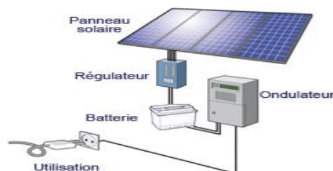
Figure 56 : Schéma de principe d'une installation autonome photovoltaïque
