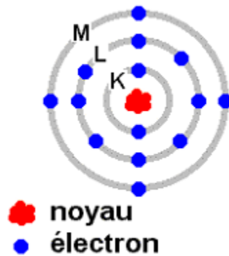
Figure 47 : Structure d'un atome d silicium
