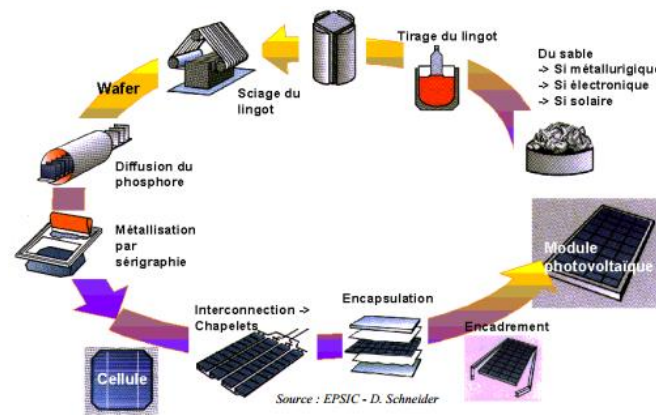
Figure 45 : Processus de fabrication des modules photovoltaïque
