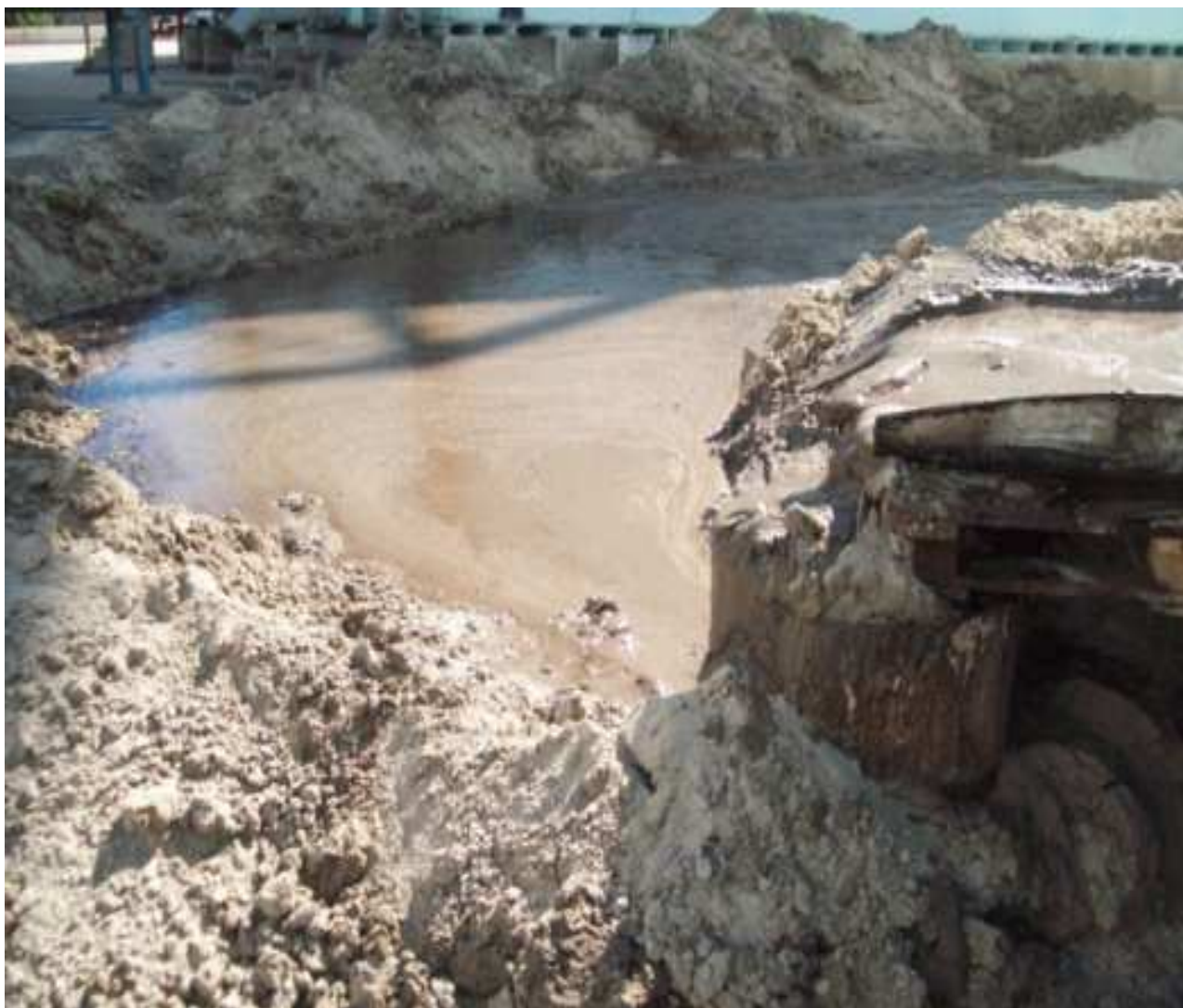
Figure 11 : Rejet du phosphogypse en grande quantité après la vidange des bacs dans les terrains à proximité de l'installation
