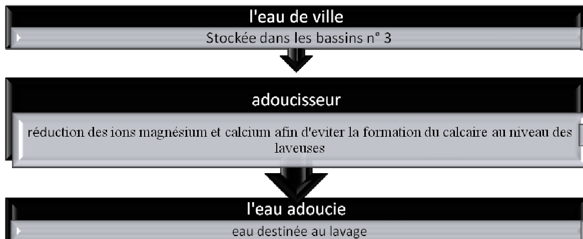
Figure 4 : Processus d'adoucissement de l'eau destinée au lavage des bouteilles.
