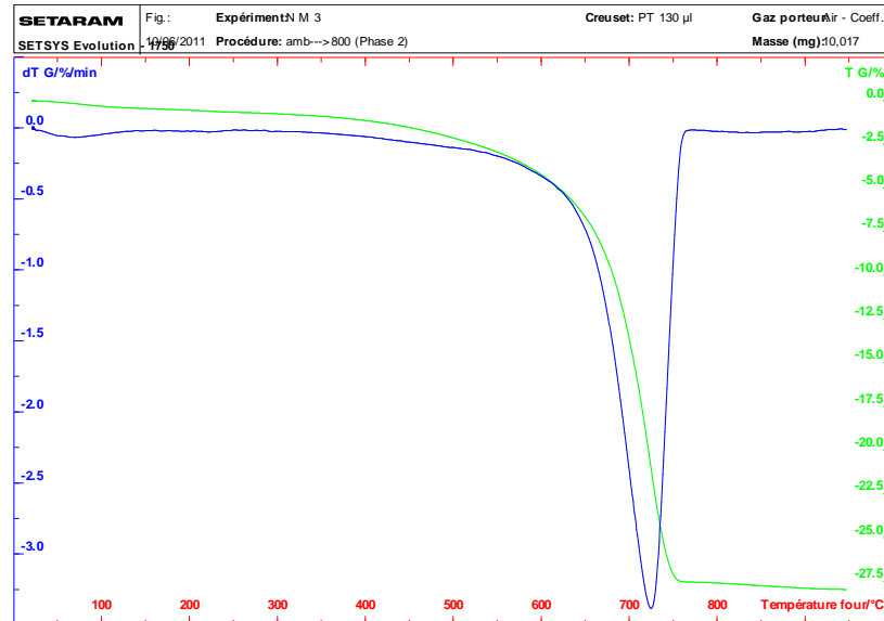
Figure 11 : résultats de l'analyse thermogravimétrique de l'échantillon ZA1
