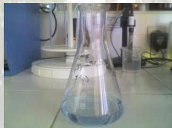
Dosage par la solution d'EDTA à 0,02 mol/l jusqu'à l'obtention de la coloration bleue.
