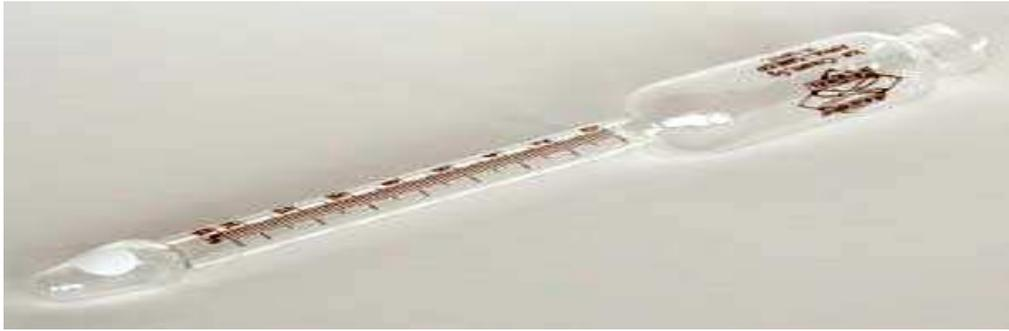
**Figure 19 : Butyromètre**
