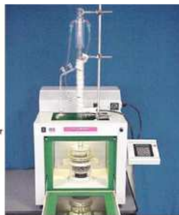
Photo 2 : photo de l'extraction par micro-ondes
