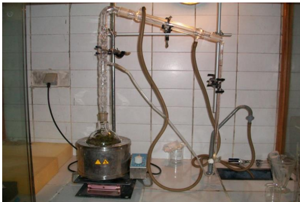
Figure 7: Appareil de type Clevenger du laboratoire de physiologie végétale – Faculté des Sciences Dhar El Mahraz- Fès.
