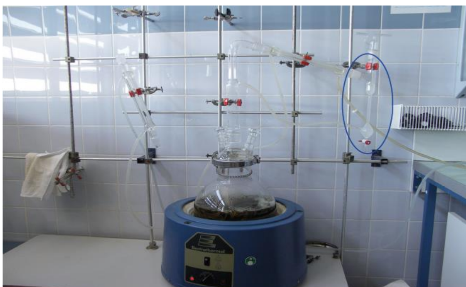
Figure3: montage d'hydrodistillation (Clevenger) (J. Smadja, 2009).
