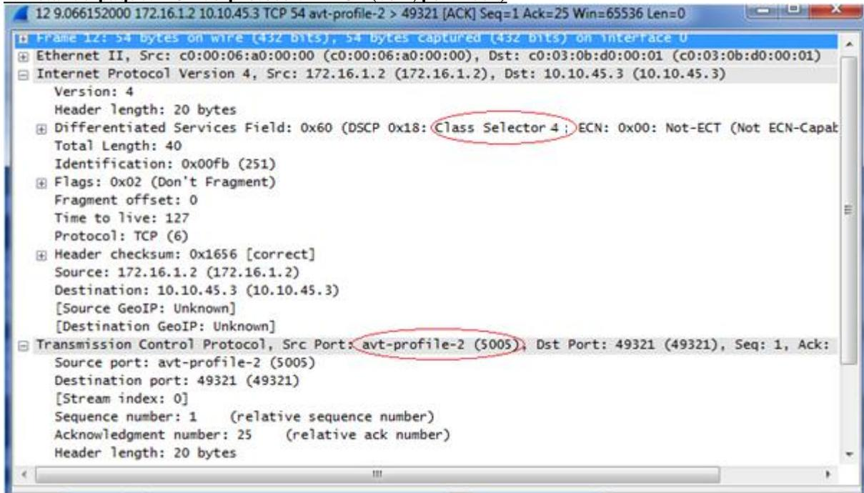
Figure C.2 : Capture trame RTCP avec Wireshark.
