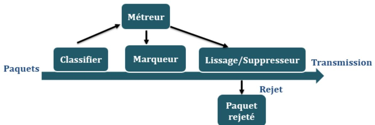
Figure 9: Mécanismes de gestion de la QoS.
