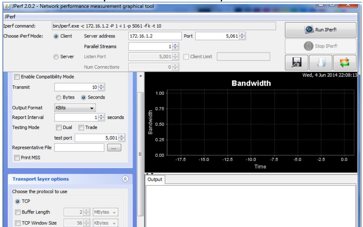
Figure 23: Configuration du Jperf en mode client.
