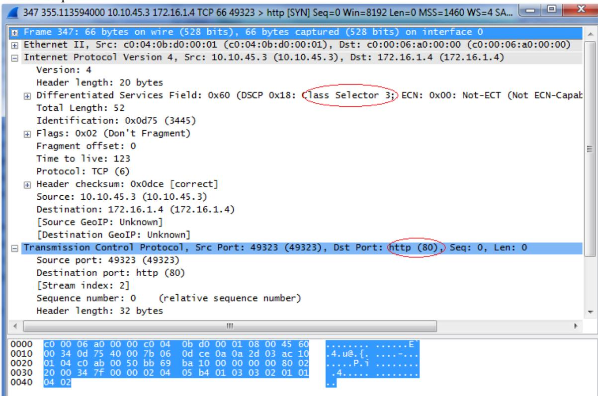
Figure C.1 : Capture trame http avec Wireshark.
