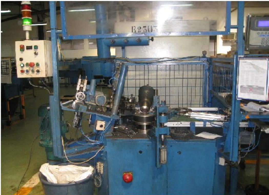
**Figure 3.9 : Machine de préformage automatique**
