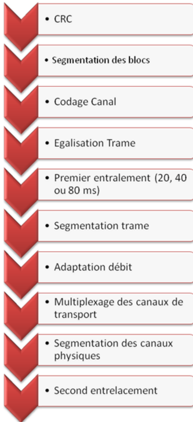
Figure 38 : Traitement de bout en bout par la couche physique
