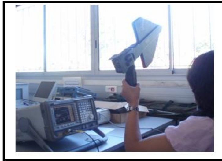
Figure 43 : Détection d'un signal 3G à l'aide d'une antenne directive
