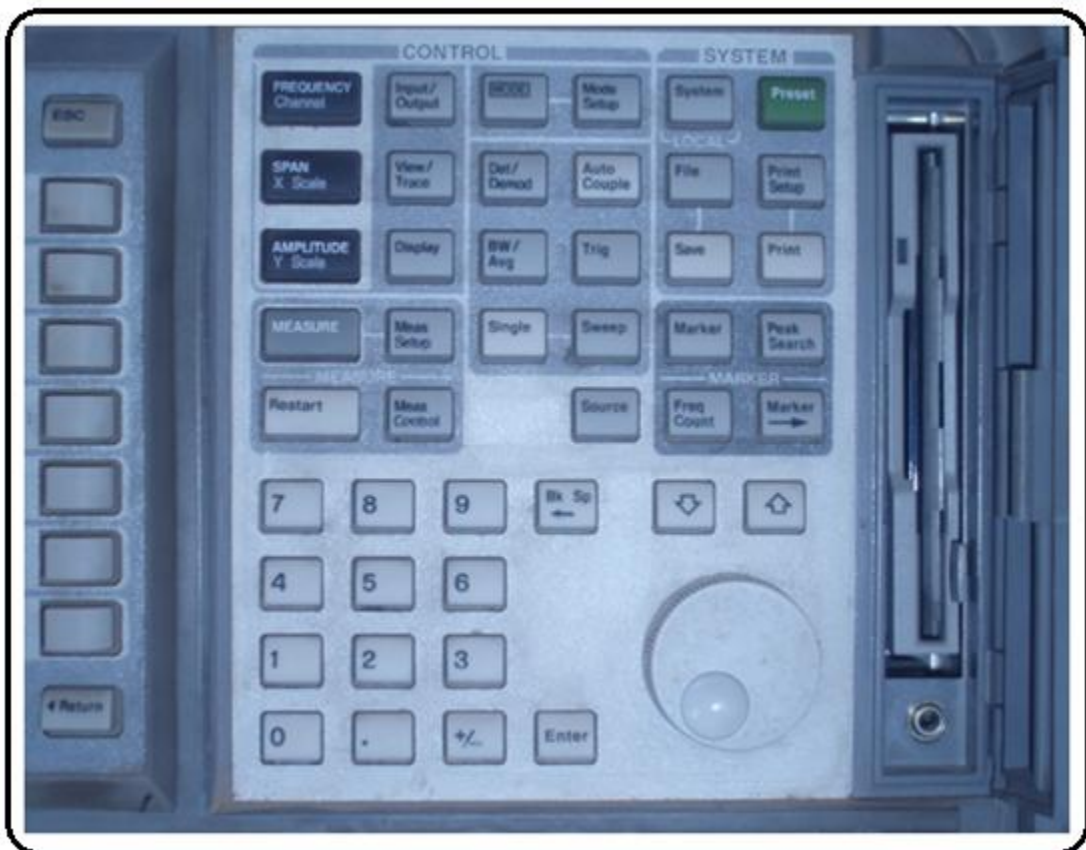
Figure 41 : Les paramètres de réglage d'un analyseur de spectre
