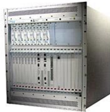
Figure 10 : Exemple d'équipement RNC
