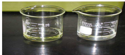
Fig.8 : Coloration jaune lors de la préparation des solutions de la gamme d'étalonnage des nitrites. Tous les réactifs doivent être exempts de composés, et l'eau utilisée doit être de l'eau distillée.
