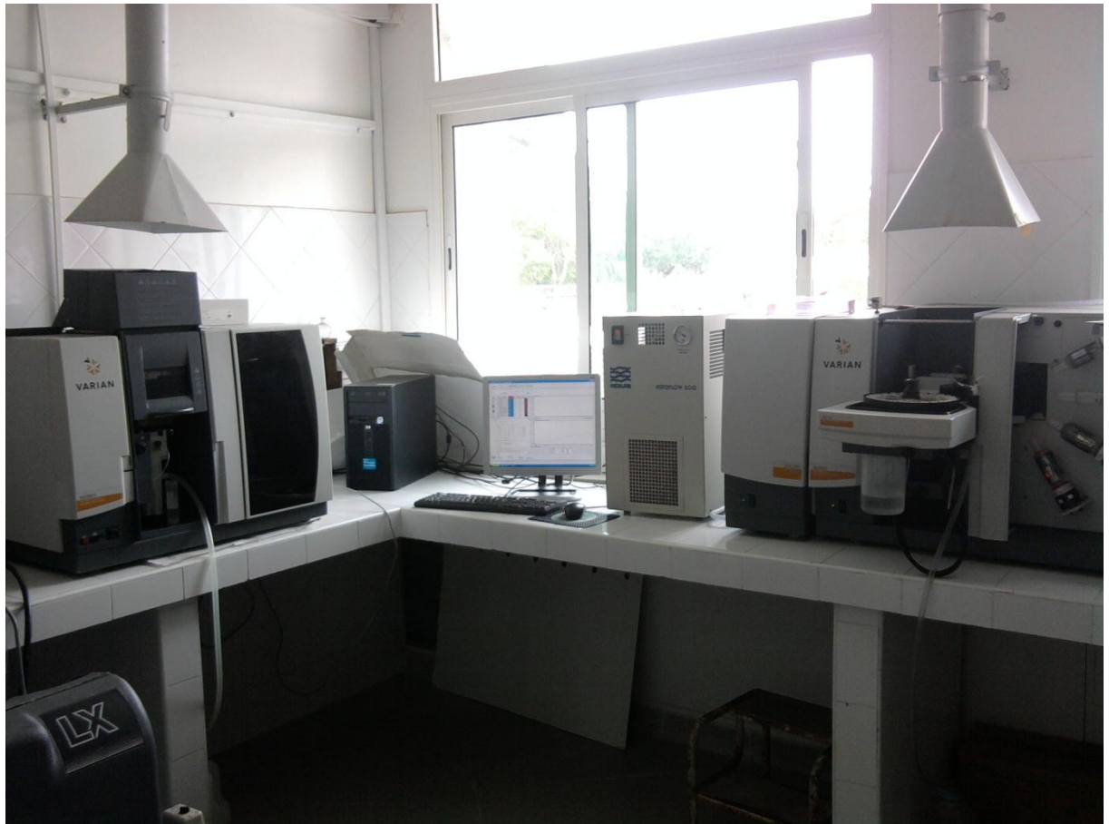
Figure8 : la spectrométrie d'absorption atomique de four et de flamme de type Varian
