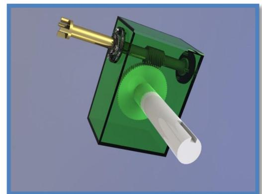
Et pour assembler le moteur et le réducteur on a utilisé un accouplement élastique. On connaît tous que la vitesse du moteur électrique est très grande, ainsi pour protéger les éléments récepteurs tels que le réducteur et les engrenages contre les accélérations brusques du moteur, on doit installer un accouplement élastique. L'accouplement est un organe qui permet la jonction du moteur au récepteur, les deux machines ayant des arbres quasiment alignés.
