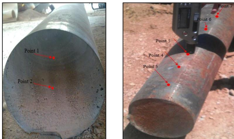
Figure 31: Les points de mesures de la dureté
