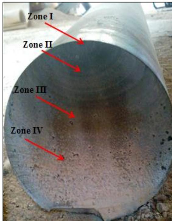
Figure 28: Les zones du faciès de rupture
