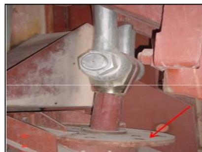
Figure 22: La plaque d'étanchéité
