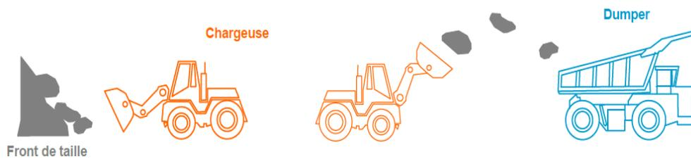
**Figure 3:Extraction et transport de la matière première**
