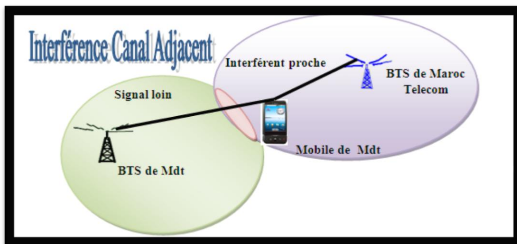
Figure 36: Perturbation de la station de base par l'émission du terminal mobile
