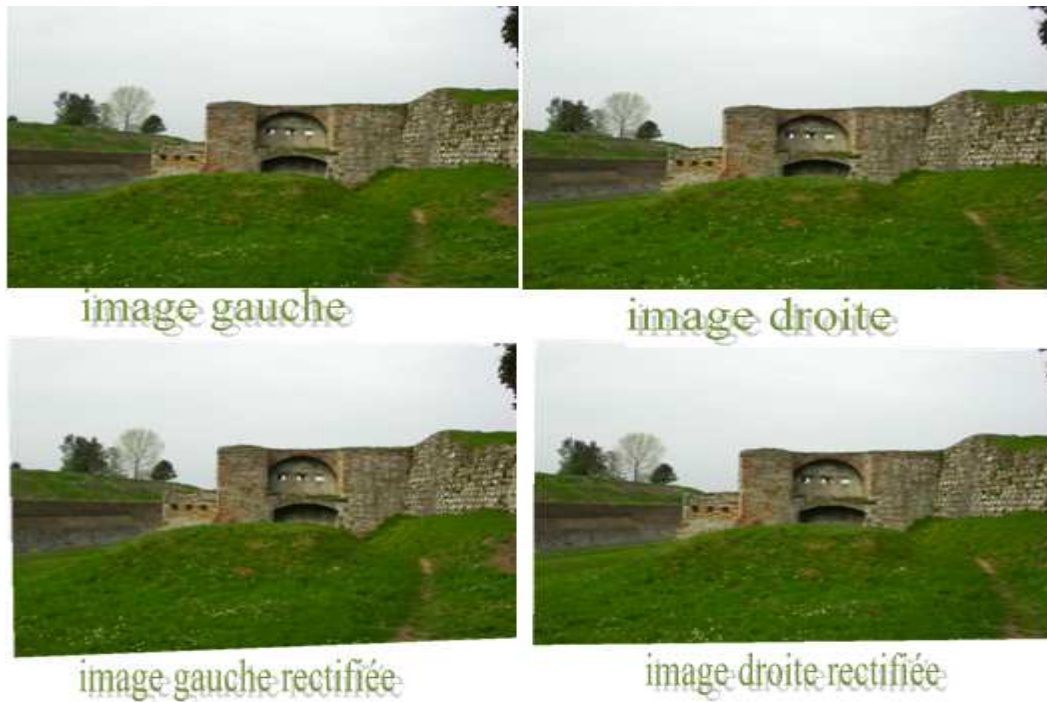
Figure 2.5 : Images stéréoscopiques avant et après rectification épi-polaire
