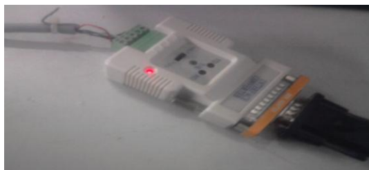
Figure 11 : Convertisseur RS232/ RS422- RS485
