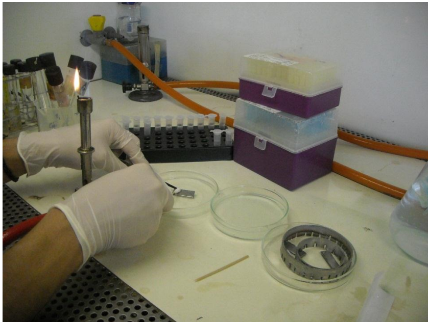
Figure 13 : Grattage de la pièce d'acier par un écouvillon
