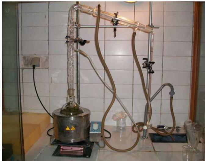
Photo 2 : Dispositif d'hydrodistillation des huiles essentielles
