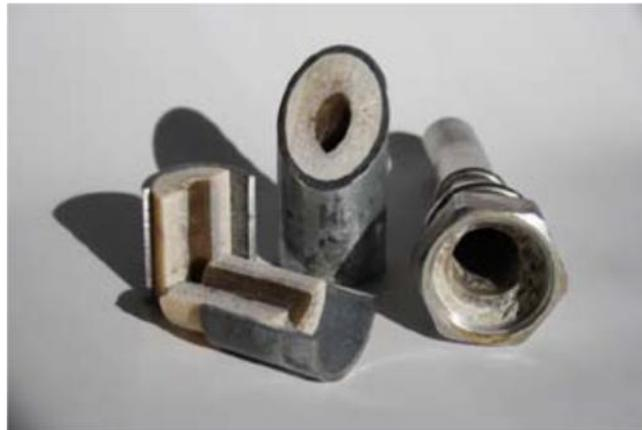
**Figure 7:** Dépôts de tartre dans des canalisations
