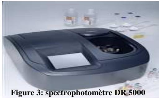
Figure 3: spectrophotomètre DR 5000
