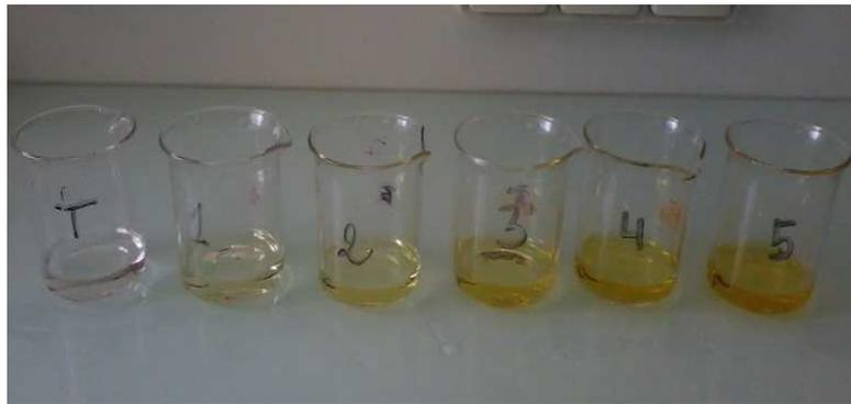
Figure 5 : Gamme d'étalonnage des nitrates
