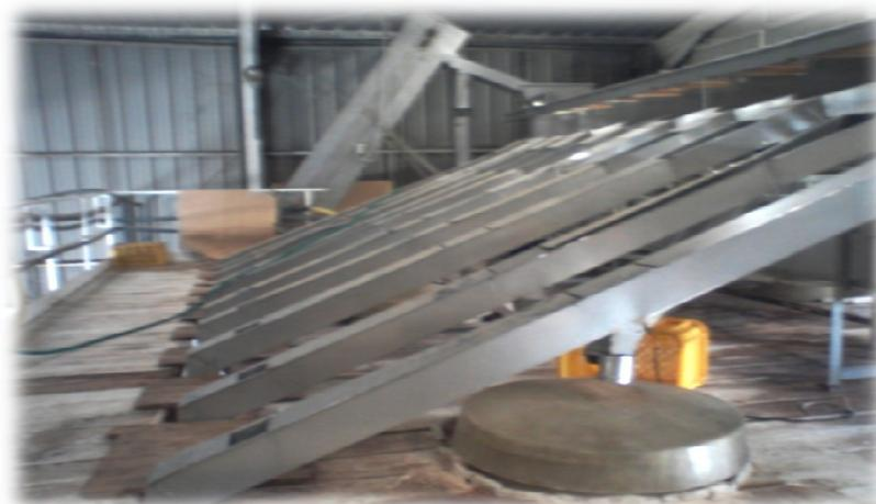
Figure 2 : machine de calibrage des olives
