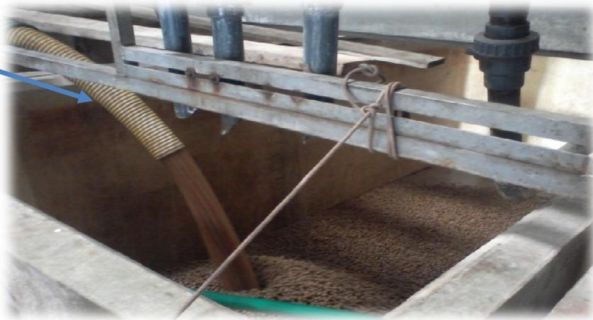
Figure 11: remplissage du bassin avec les olives destinées a l'oxydation
