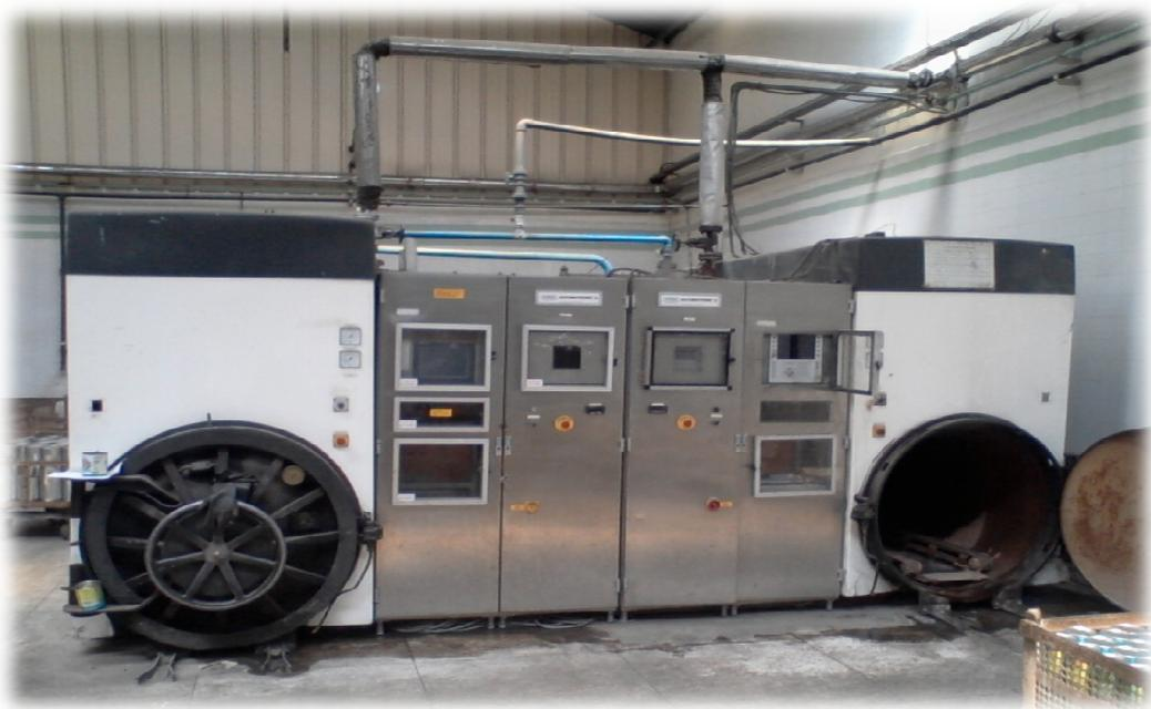
Figure 10 : autoclave à double entrée
