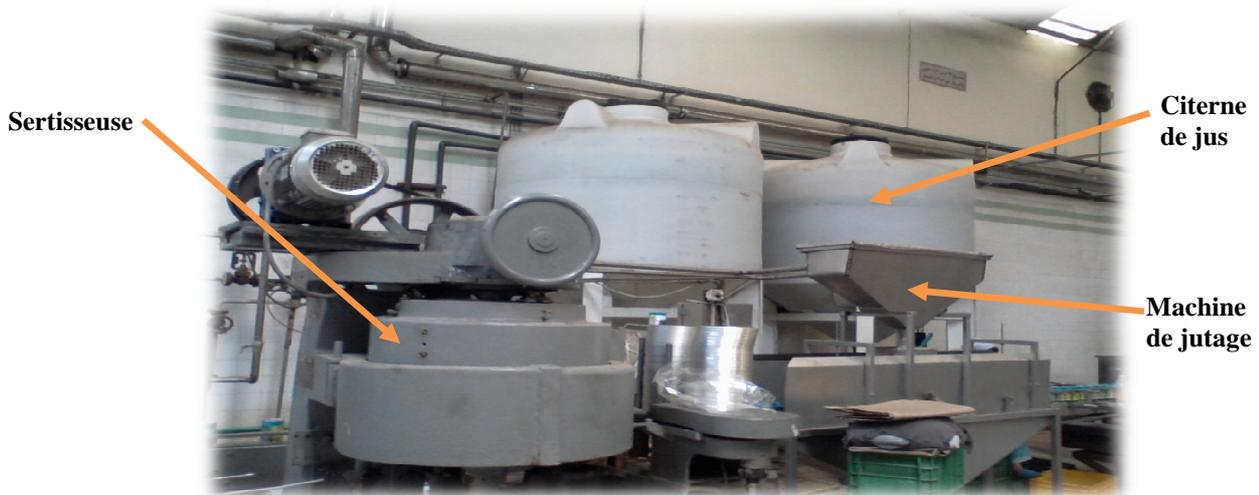
Figure9 : machine de jutage et machine de sertissage
