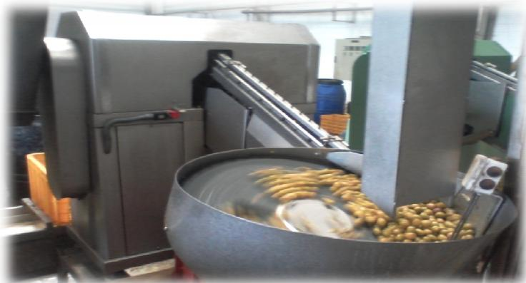
**FIGURE N°9 : CONDUCTEUR DES OLIVES VERS LA DENOYAUTEUSE**
