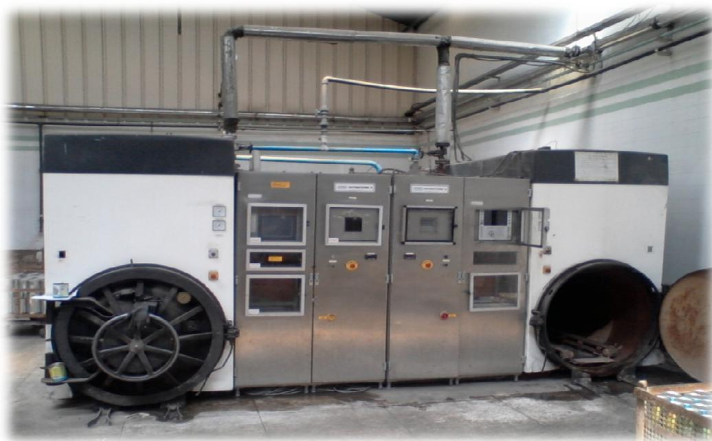
**FIGURE N°16 : AUTOCLAVE, MACHINE DE STERILISATION**
