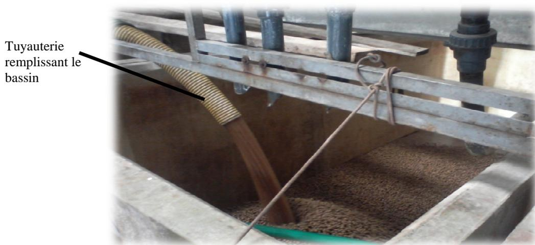
FIGURE N°17 : REMPLISSAGE DU BASSIN AVEC LES OLIVES DESTINEES A L'OXYDATION
