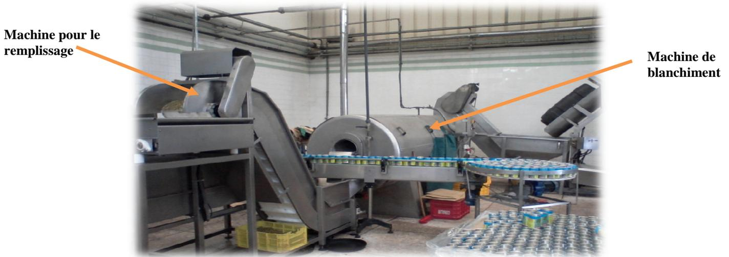
**FIGURE N°13 : MACHINE DE BLANCHIMENT DES OLIVES**
