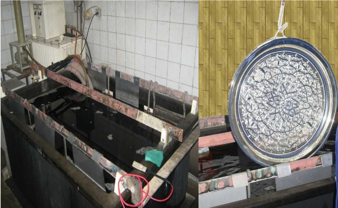
Fig.10 : Bain d'argent et pièce argentée
