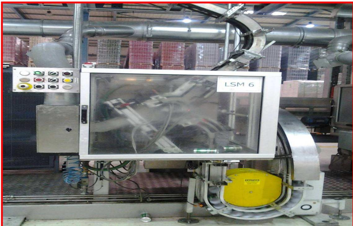
**Figure 7:** *Vernisseuse à pistolet (LSM 3200)*
