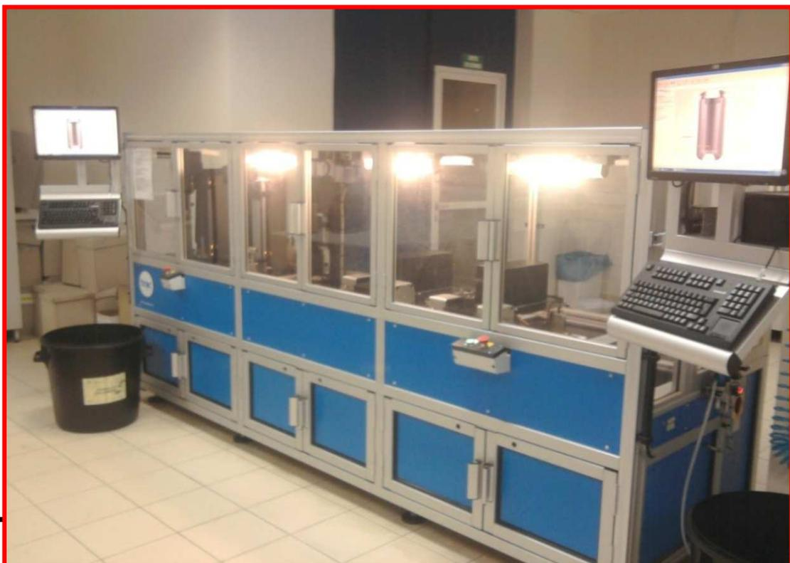
**Figure 2:** Machine TRAC pour le contrôle dimensionnel et la résistance des canettes
