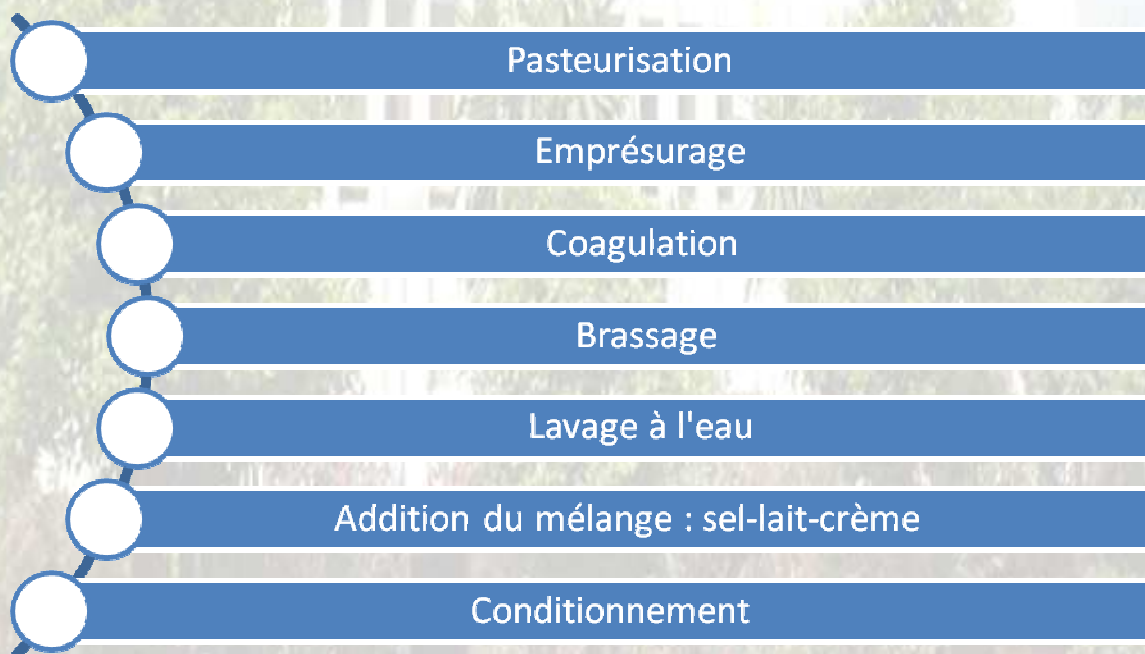
Figure 14: le processus de la fabrication du cottage chéfesse
