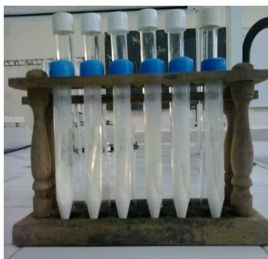
**Figure 15 : Centrifugation du lait UHT et séparation du culot et de surnageant**
