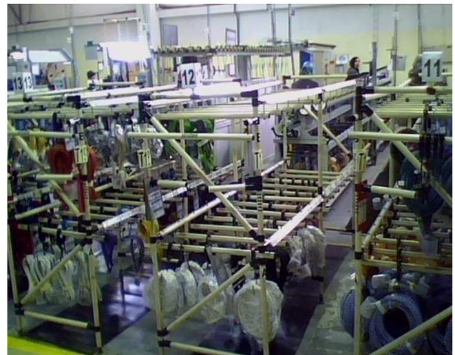
Figure 4.4: stock de préparation sous dimensionné
