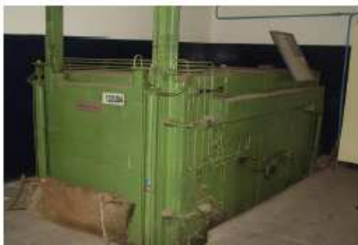
Figure 10 : Four de stabilisation
