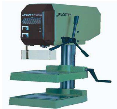
**Figure 17 - Perceuse à colonne.**
