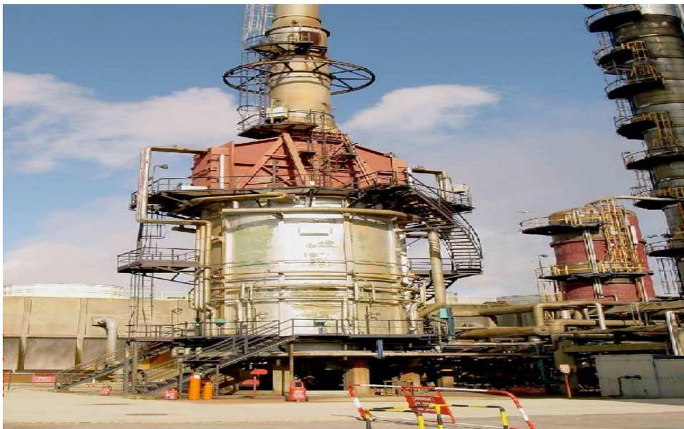
Figure 6: Four cylindrique à tubes « 011F1 »
