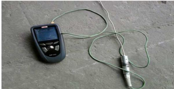
Figure 26 : Sonde de température (matériel de mesure)
