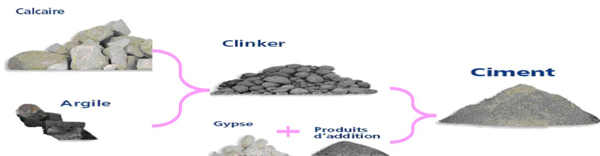
Figure 19 : Matières utilisées dans la production du ciment
