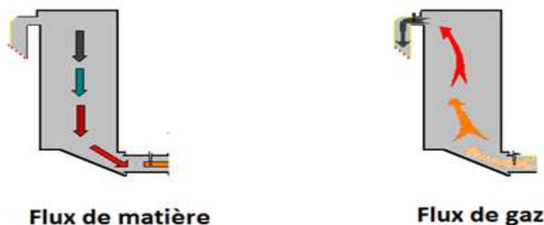
Figure 12 : Différents flux dans la tour de préchauffage
