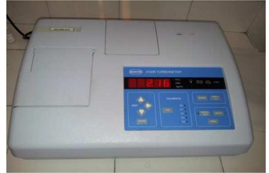
**Figure 7 : Turbidimètre.**
