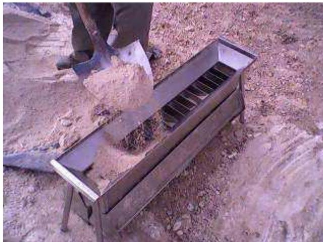
Figure 7 : Homogénéisation des cuttings pour l'échantillonnage
