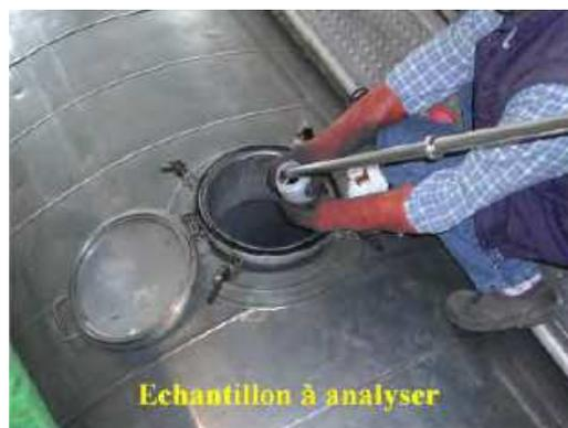
**Figure 33 : Prélèvement du COKE de PETROLE**
