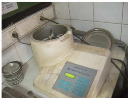
Figure 36 : Machine vibratoire pour le tamisage
