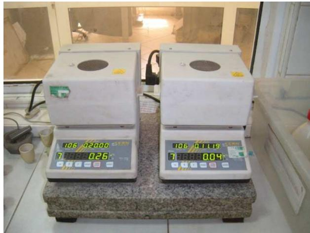
*Figure 37 : Machine pour la mesure de l'humidité*
