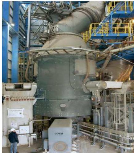
**Figure 20 : Broyeur vertical ou à galets**
