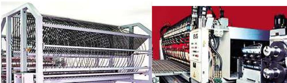
Figure N° 9 : ligne de soudage des nappes d'armature
