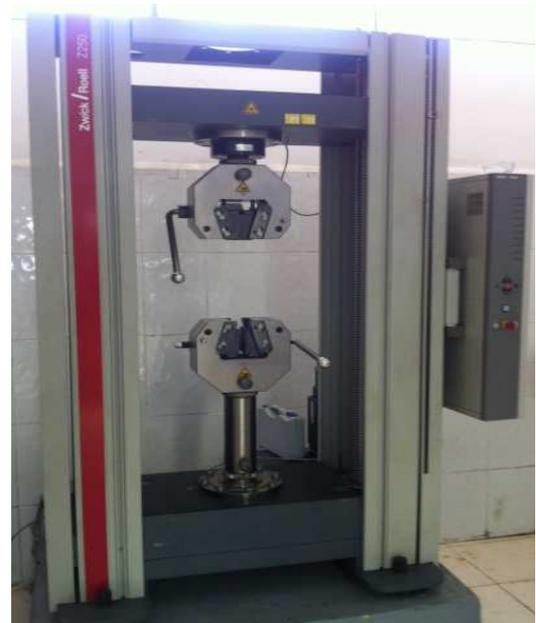
Figure°28 : Machin d'essai de traction150 kN
