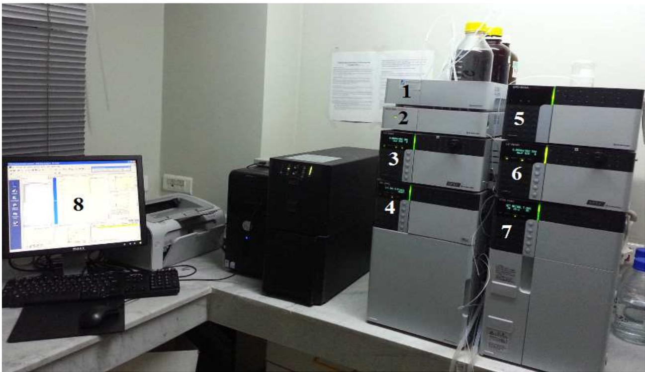
**Figure 8 :** Image de l'appareil HPLC Shimadzu.
