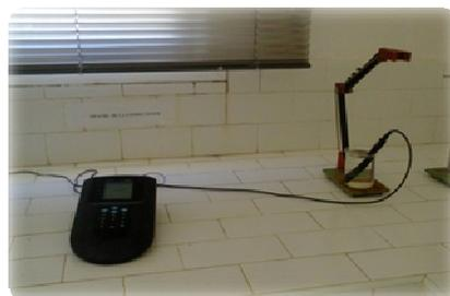
Figure15 : Conductivimètre
