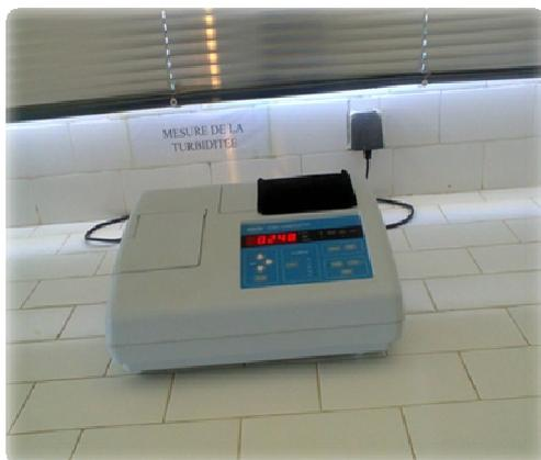
figure12 : Turbidimètre
